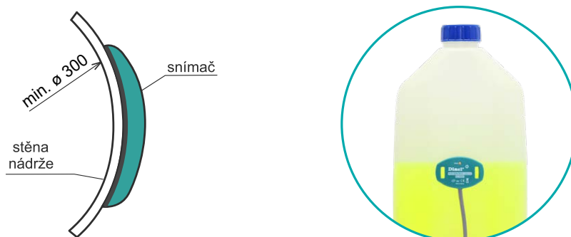
Upevnění FLD-32 pomocí samolepicí vrstvy
