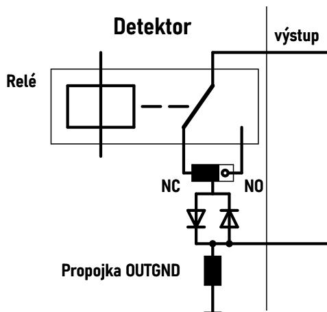
Pokud je tato funkce zapnuta, tak je hlídáno minimální napětí 0,3 V v sepnutém stavu. Pokud je napětí na vstupu nižší, je vyhlášena chyba vstupu označená jako ERROR2 a jsou aktivována relé se zapnutou odezvou na chybu.
