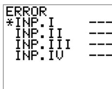
U zdroje lze nastavit kombinaci vstupů, která je vyhodnocena jako chyba. Připojíme-li například dvoustupňový detektor hořlavého plynu na vstupy I (nižší stupeň odpovídající 10% LFL) a II (vyšší stupeň odpovídající 20% LFL), tak v případě, že je alarm indikován pouze na vstupu II (detektor indikuje, že byla překročena úroveň 20% LFL, ale úroveň 10% LFL překročena nebyla), tak muselo dojít k chybě. Zdroj vyhodnotí a zobrazí tuto chybu.
